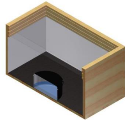
Figura 2 Estufa solar (corte).
