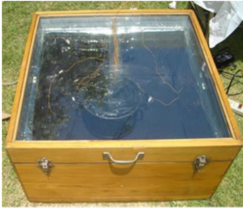
Figura 1 Estufa solar tipo caja con reflectores internos.
